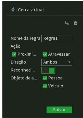
Configuração de nome, ação e direção da linha virtual
