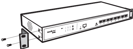
Instalación de los soportes en la central
