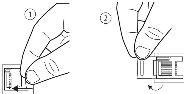
4. Após inserir o cartão micro-SD (3), baixe a grade (4) novamente e trave-a empurrando a grade para trás (5), conforme figura abaixo.
