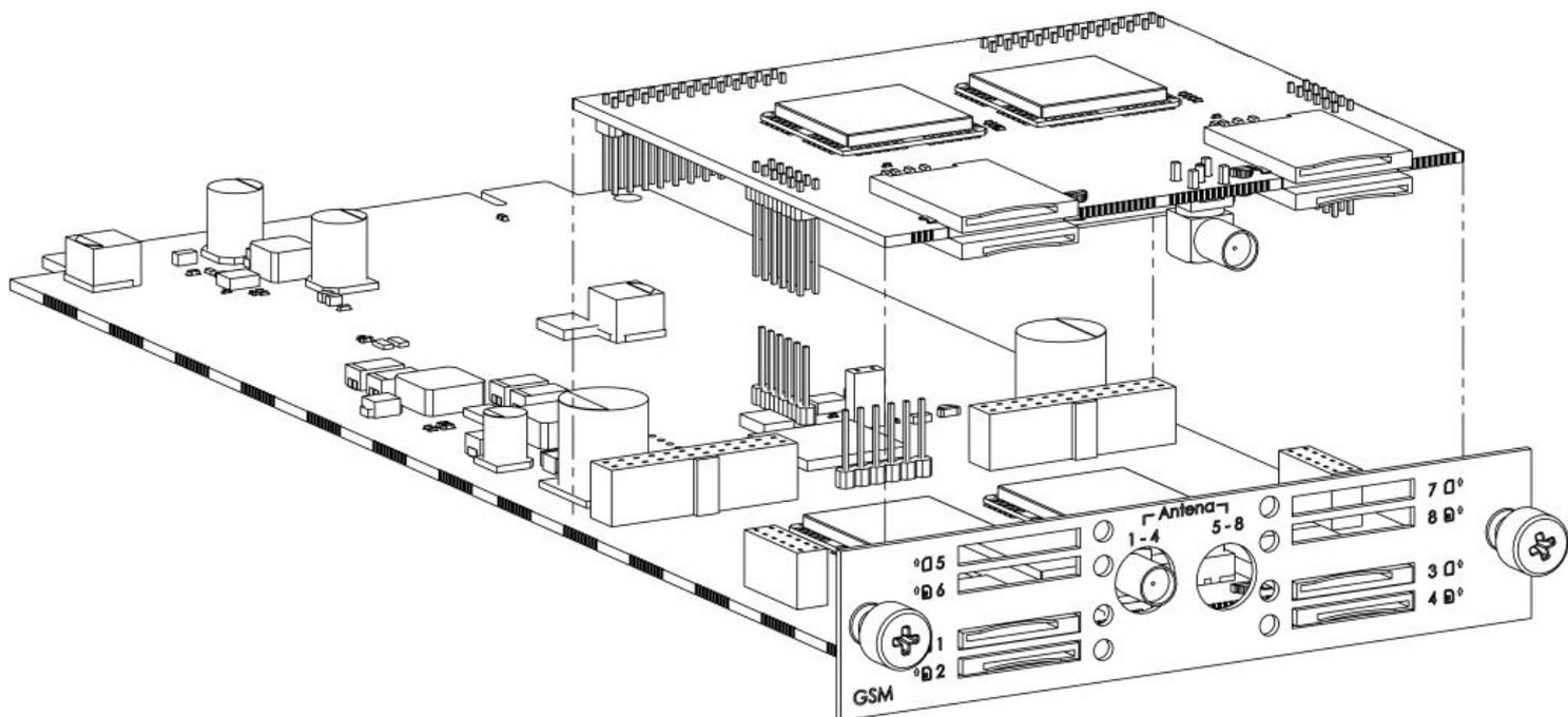
Instalação da expansão na tronco GSM/3G
