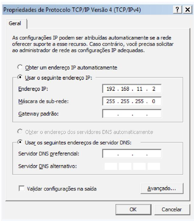
5. Após alterar o endereço IP do seu computador para 192.168.11.2, será necessário inserir o endereço IP 192.168.11.1 em seu navegador, para realizar o acesso ao gerenciador de configuração.
