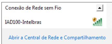
A central IAD 100 possui habilitado em seu padrão de fábrica o servidor *DHCP*, desta forma, ao se conectar à rede apresentada pelo dispositivo, seu computador automaticamente irá receber um endereço IP. Após entrar na rede, será possível acessar a interface de programação. Através de um navegador de internet (Internet Explorer®, Mozilla Firefox® ou Google® Chrome) insira o endereço IP *192.168.11.1*.
