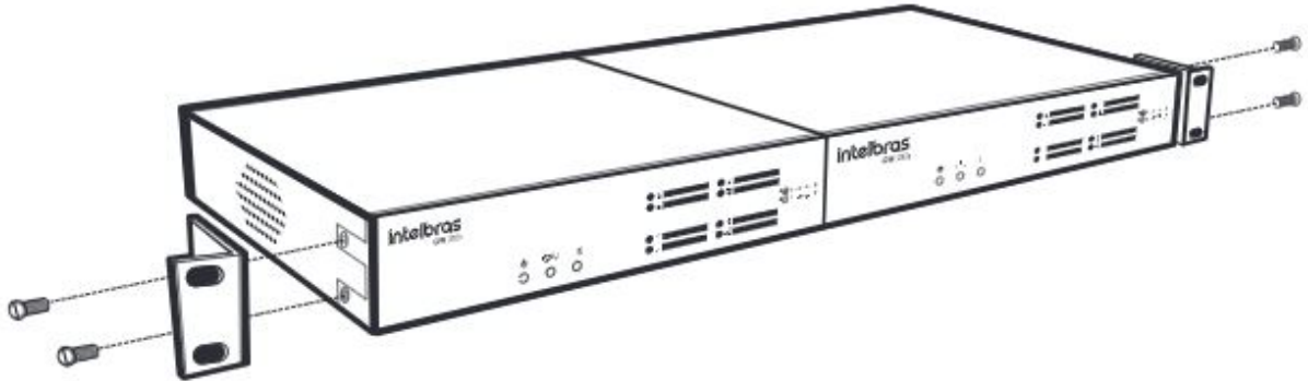
Instalação com dois gateways
