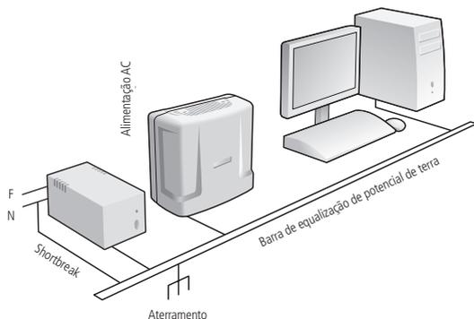
A forma ideal para o aterramento da central é a criação de uma barra de equalização de potencial de terra. Nessa barra, deve estar ligado o neutro da energia elétrica, o terra da central, as proteções da entrada AC, as proteções dos ramais e o fio terra de qualquer outro equipamento ligado à central.
