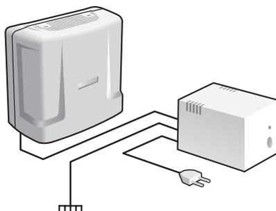
A central pode ser ligada em 110 ou 220 V (50/60 Hz). A seleção da tensão é automática. Para evitar a interrupção do funcionamento da central de portaria, indica-se a utilização de um nobreak ou shortbreak.
