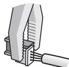
3. Use um alicate tipo universal para travar as duas partes do conector.
