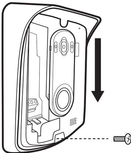
Se desejar, fixe o parafuso da parte superior do produto instalando uma bucha de 6 mm na parede, isso permitirá melhor fixação do aparelho.
