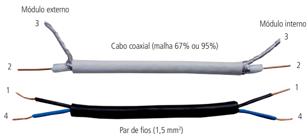
Instalação com cabo coaxial até 100 metros
