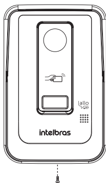
Fixação da tampa de acabamento
