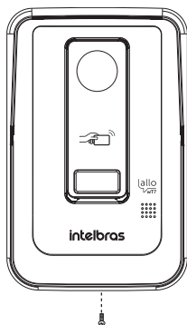
Fixação da tampa de acabamento
