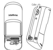
**Obs.:** para facilitar a instalação utilize os rebaiços na tampa traseira para passagem dos cabos.
