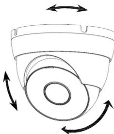
2. Fixe a base da câmera junto com a dome em uma superfície estável, utilizando os parafusos e as buchas que acompanham o produto. Lembre-se de ajustar o cabo BNC que está conectado ao dome da câmera para que ele se encaixe na guia da base para o cabo;
