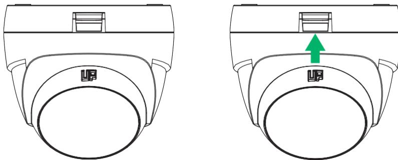
2. Fixe a base da câmera junto com a dome em uma superfície estável, utilizando os parafusos e as buchas que acompanham o produto. Lembre-se de ajeitar o cabo BNC que está conectado ao dome da câmera para que ele se encaixe na guia da base para o cabo;
