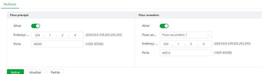
Na tela acima são configurados o IP e a porta do Multicast, tanto para o Stream principal como para o Stream extra. Para visualizar o Stream Multicast, é necessário acessar a *Local* e selecionar o protocolo conforme imagem a seguir:
