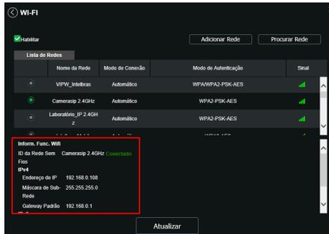
Após a configuração do dispositivo a câmera pode ser acessada através da rede Wi-Fi, e para verificar o endereço de rede que a mesma está utilizando basta conferir abaixo da mensagem *Conectado*. Sendo assim desnecessário o uso do cabo de rede.
