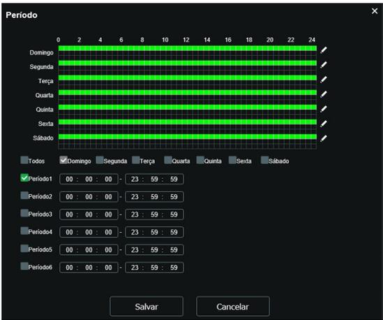
A tela de configuração de Período de funcionamento mostra um gráfico de 24 horas dividido por dias da semana (Domingo a Sábado). Cada dia possui uma barra horizontal com uma faixa verde indicando o período de detecção. Abaixo do gráfico, há uma lista de dias com checkboxes para selecionar o dia a ser configurado. Abaixo disso, há seis campos de configuração de período, cada um com um checkbox e dois campos de hora (inicial e final):
