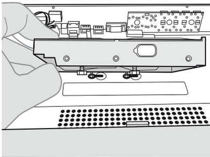
5. Vire o NVR e aperte os parafusos firmemente;
