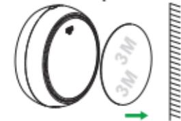
Para instalar o sensor na parede, deve-se colar a fita adesiva na tampa traseira e colar o sensor no local desejado.
