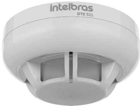
O sensor de temperatura do DTE 521 monitora com precisão as variações de temperatura ambiental que ultrapassam o valor pré-determinado (temperatura fixa) ou uma elevação brusca (termovelocimétrico), identificando inclusive elevações de temperatura geradas por fontes de combustão limpa que não geram fumaça visível.
