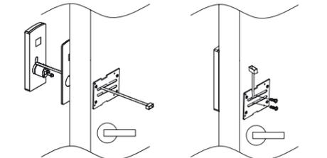
**Importante:** para portas com espessura inferior a 35 mm, remova os parafusos G (M5 x 30 mm) que acompanham a unidade externa.
