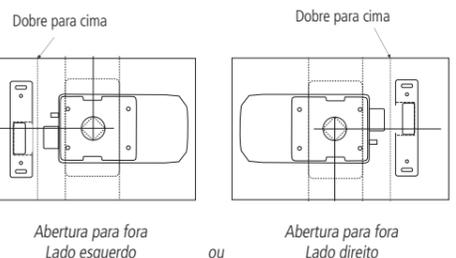
2. Utilizando o gabarito de instalação, marque os 4 furos do batente para fixação posterior. Logo após, marque e faça o furo de 32 mm utilizando uma serra-copo;
