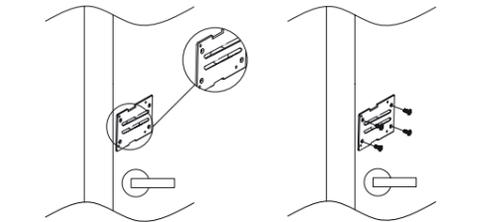
4. Passe o cabo da unidade externa pela chapa de fixação. Para portas com espessura de 25 a 40 mm, parafuse a unidade externa utilizando dois parafusos B (M5 x 20 mm). Para portas com espessura de 41 a 50 mm, parafuse a unidade externa utilizando dois parafusos C (M5 x 35 mm);
