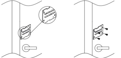
4. Passe o cabo da unidade externa pela chapa de fixação. Para portas com espessura de 25 a 40 mm parafuse a unidade externa utilizando dois parafusos B (M5 x 20 mm). Para portas para portas com espessura de 41 a 50 mm parafuse a unidade externa utilizando dois parafusos C (M5 x 35 mm);
