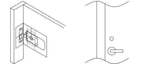
3. Posicione a chapa de fixação sobre o furo, conforme a imagem a seguir. Utilize 4 parafusos A (M4 x 20 mm) para fixar a chapa;
