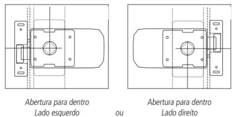
2. Utilizando o gabarito de instalação, marque e faça o furo de 32 mm utilizando uma serra-copo;
