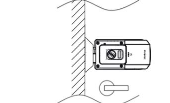
1. Inicie pelo lado interno da porta. Localize o gabarito e dobre para cima sobre a indicação pontilhada. Posicione o gabarito de furação sobre a porta na altura desejada. Recomenda-se instalar o produto acima da maçaneta/puxador;
