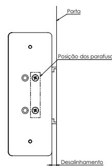
Para o melhor rendimento de tração da fechadura, respeite os limites de distância entre a porta e a bandeira (limite máximo de 7 mm e o limite mínimo de 5 mm).
