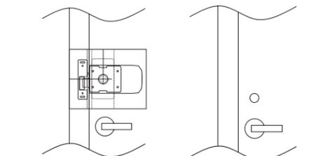
3. Ainda no lado interno da porta, posicione a chapa de fixação sobre o furo, conforme a imagem a seguir. Utilize 4 parafusos A (M4 x 20 mm) para parafusar a chapa de fixação;
