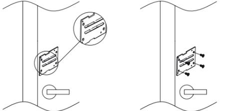
4. Passe o cabo da unidade externa pela chapa de fixação. Para portas com espessura de 25 a 40 mm parafuse a unidade externa utilizando dois parafusos B (M5 x 20 mm). Para portas para portas com espessura de 41 a 50 mm parafuse a unidade externa utilizando dois parafusos C (M5 x 35 mm);
