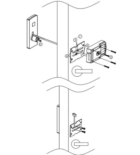
**Importante:** para portas com espessura inferior a 35 mm, remova os parafusos G (M5 x 30 mm) que acompanham a unidade externa.
