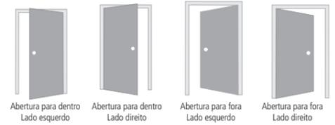
**Importante:** evite instalar a fechadura próxima às extremidades superior e inferior da porta a fim de evitar o efeito alavanca ou dificultar seu pleno manuseio. Este produto não substitui a maçaneta da sua porta. Siga as instruções a seguir de acordo com o seu cenário de instalação.
