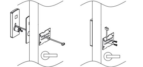
**Importante:** para portas com espessura inferior a 35 mm, remova os parafusos G (M5 x 30 mm) que acompanham a unidade externa.
