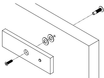
Se necessário, ajuste a distância entre o suporte do blanque e a fechadura (máx. 14 mm).
