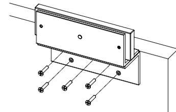
Exemplo de instalação da fechadura em porta com abertura para FORA do ambiente.
