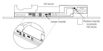
No caso de utilizar a fechadura no modo Fail safe, retire o jumper, faça o acionamento manual puxando a trava branca conforme imagem a seguir até alinhar os furos, inserindo o segundo parafuso incluso na embalagem no segundo furo.
