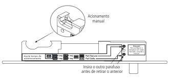
2. Por fim, retire o primeiro parafuso. A fechadura deverá ficar configurada como na figura a seguir:
