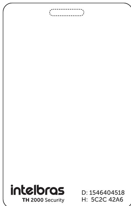
O TH 2000 Security é um cartão RFID com código único pré-gravado de 64 bits, com tecnologia de criptografia Security, com impressão de IDs nas laterais. Feitos em PVC, são resistentes e apresentam ótimo desempenho de leitura. Compatível com a linha Security Intelbras. Ambos os lados podem ser utilizados para impressão em off-set, termo transferência e sublimação (dye sublimation).
