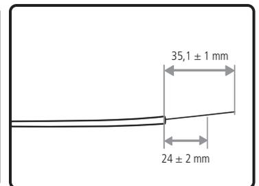
8. Siga essa especificação da fibra para a montagem no conector
