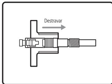
1. Desloque a chave para a posição indicada para destravar
