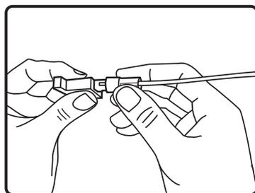
3. Trave o cabo no conector com a rosca de fixação.
