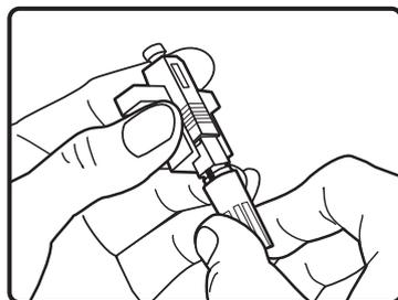
3. Retire a rosca para fixação do cabo
