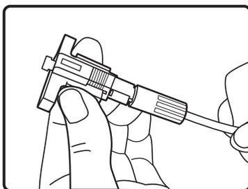
4. Fixe a fibra óptica no conector, deslocando a chave para a extremidade do conector de campo.
