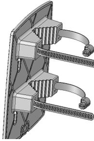
Para montagem em parede, fixe primeiro o suporte na parede e depois encaixe o APC 5A.
