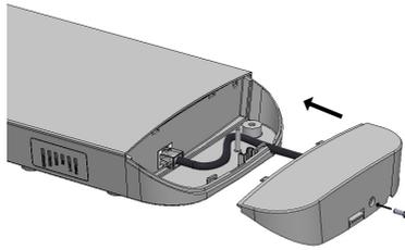
4. Insira a tampa de proteção e fixe-a com o parafuso;
