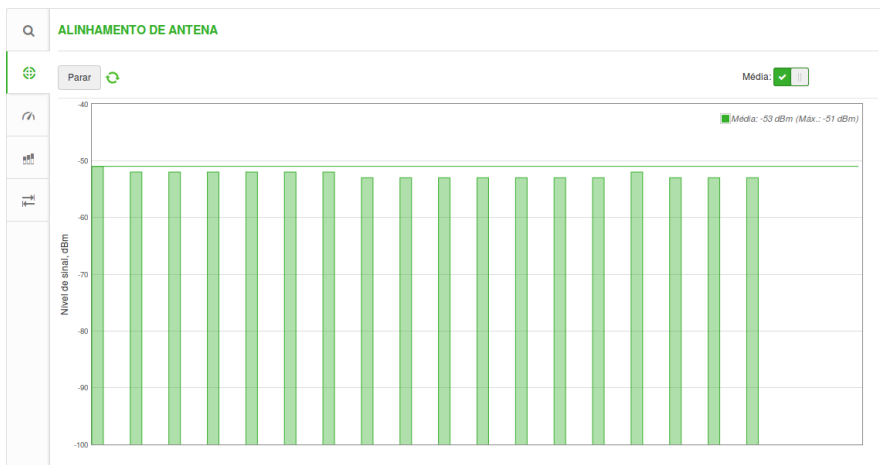
Alinhamento de antena – Média
