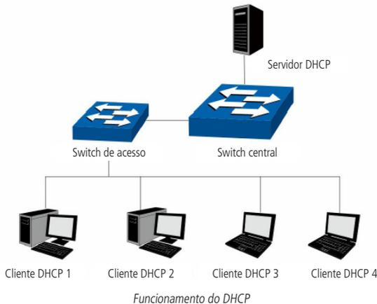
O servidor *DHCP* fornece três métodos de atribuição de endereços *IPs*.
