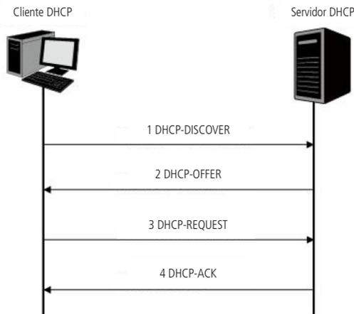
1. **DHCP-DISCOVER:** o cliente transmite em broadcast o pacote *DHCP-DISCOVER* para descobrir o servidor *DHCP*.
