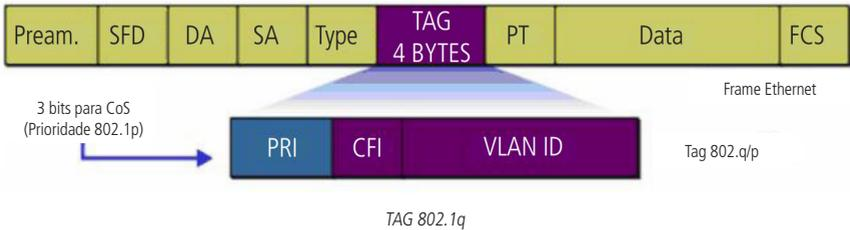
De acordo com a figura anterior, cada tag 802.1q inserida no quadro Ethernet possui um campo denominado *PRI*, este campo possui 3 bits que são utilizados para a classificação e priorização do pacote, sendo possível configurar até 8 níveis de priorização (0 a 7).
