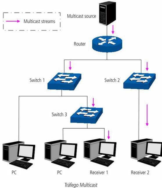
O IGMP Snooping é um mecanismo de controle Multicast, que pode ser usado no switch para registrar dinamicamente um grupo Multicast. O switch executando o IGMP snooping, gerencia e controla o grupo Multicast escutando e processando mensagens IGMP transmitidas entre os clientes e servidores Multicast, determinando os dispositivos conectados a ele e que pertencem ao mesmo grupo, evitando desta forma que os grupos Multicast transmitam pacotes via broadcast na rede.
