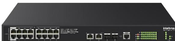
» 16 portas Gigabit Ethernet PoE e 4 portas Uplink, sendo 2 delas SFP.
