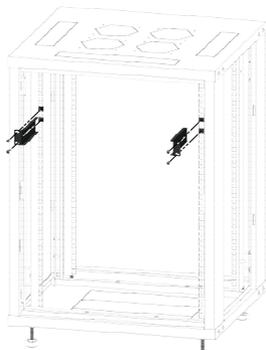
» **Passo 02:** encoste as abas do acessório no perfil vertical de seu rack e fixe com os conjuntos de porca gaiola nos espaços correspondetes do U desejado.
