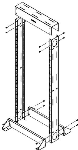
Posicionar as peças e após fixá-las com os parafusos nos locais indicados conforme imagem.
