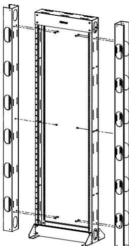
Remova as tampas laterais, posicione as molduras no local indicado de seu Rack RT(36U/44U) e as fixe parafusando nos locais indicados.
