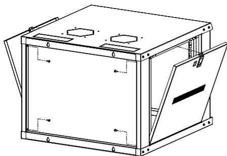
Para inserir os fechamentos laterais é necessário inclina-los de modo que suas abas que se encontram na parte inferior se encaixem na cavidade presente na base. Para finalizar esta etapa, aperte o par de fechos presentes em cada fechamento lateral, soltando-os após as faces das colunas, base, tampa e fechamentos laterais se alinharem na montagem. Para a fixação do fechamento posterior, alinhe seus furos com os furos da estrutura já montada – base, tampa e colunas.
