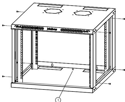
Insira os perfis verticais dentro do Rack de modo que permaneça alinhado com os respectivos furos da base e da tampa. Garantindo que os furos estejam alinhados, fixe os perfis com os parafusos nos locais indicados.
