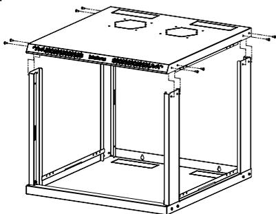
Agora, posicione a tampa superior de modo que a mesma se encaixe nas colunas já fixadas e também de modo que os furos da tampa e das colunas estejam alinhados. Para finalizar esta etapa, faça a fixação da tampa utilizando os parafusos, conforme indicado pela imagem.
