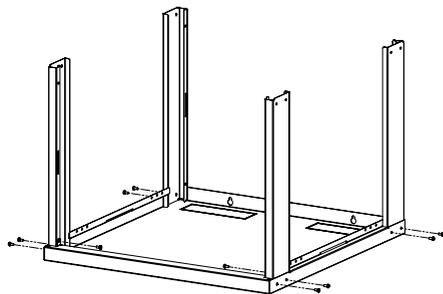
Com a base posicionada, alinhe as colunas nos espaços indicados. Fixe cada coluna com a base de forma que os furos de cada coluna fiquem alinhados com os da base.
