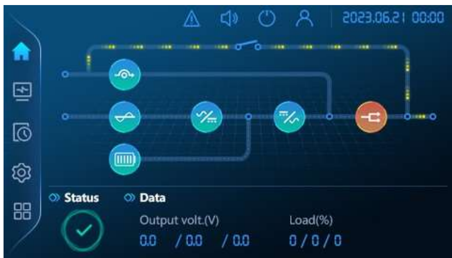
Saída de bypass de manutenção
