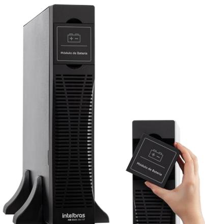
O MB 0609 36 V RT é um módulo de baterias formato rack/torre. Possui 6 baterias seladas de chumbo-ácido (VRLA) 12 V 9 Ah e é compatível com os nobreaks DNB 1.5 kVA RT, de topologia online de dupla conversão e formato de onda senoidal.
