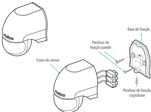
Fixação e instalação do sensor ESP 180
