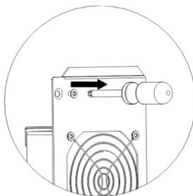
3. Desconecte o cabo das ventoinhas e remova as grades de proteção, conforme a seguir.
