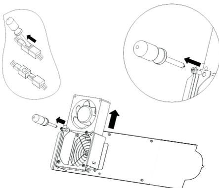
4. Limpe as ventoinhas, as grades de proteção e o dissipador de calor ou substitua a ventoinha em caso de defeito;
