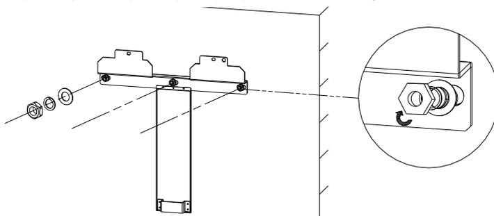
3. Levante o inversor um pouco mais alto que o suporte. Devido ao peso do inversor, podem ser necessárias ferramentas adicionais para levantá-lo. Para isso, utilize as alças de içagem que ficam na parte superior do inversor. Certifique-se de manter o equilíbrio do inversor durante o processo, conforme mostrado na figura abaixo.
