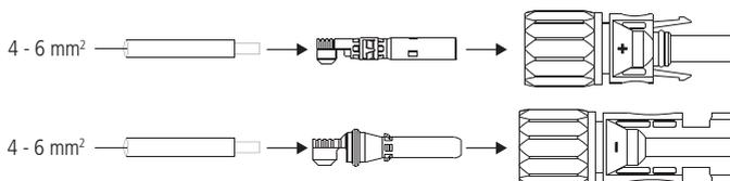
1. Para ligação do arranjo fotovoltaico ao inversor utilize cabo isolado apropriado para o uso em sistemas fotovoltaicos;
