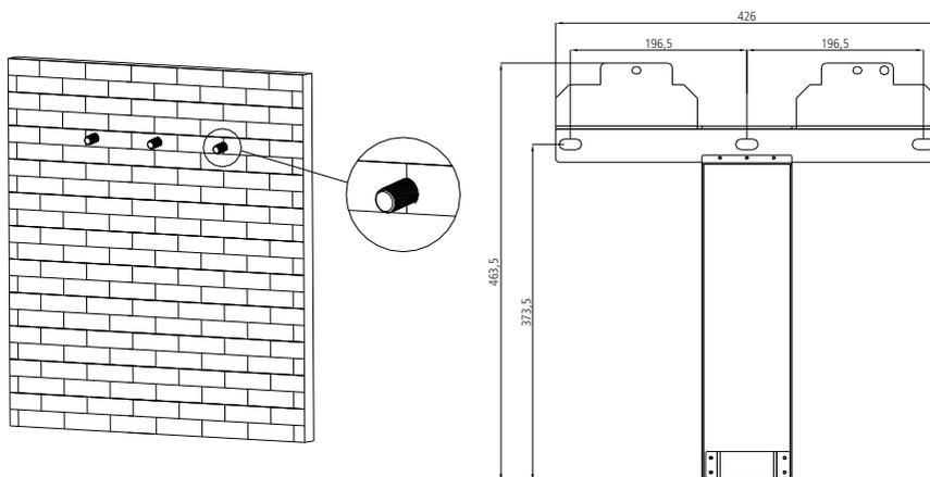
2. Posicione o suporte na parede e aperte as porcas para prendê-lo, conforme a figura abaixo.
