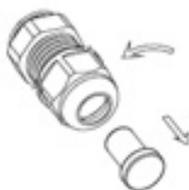
3. Passe o(s) cabo(s) através do orifício do prensa-cabo e o conecte-o(s) ao(s) plugue(s) do conector RS-485. O cabo recomendado para essa conexão é o STP.
