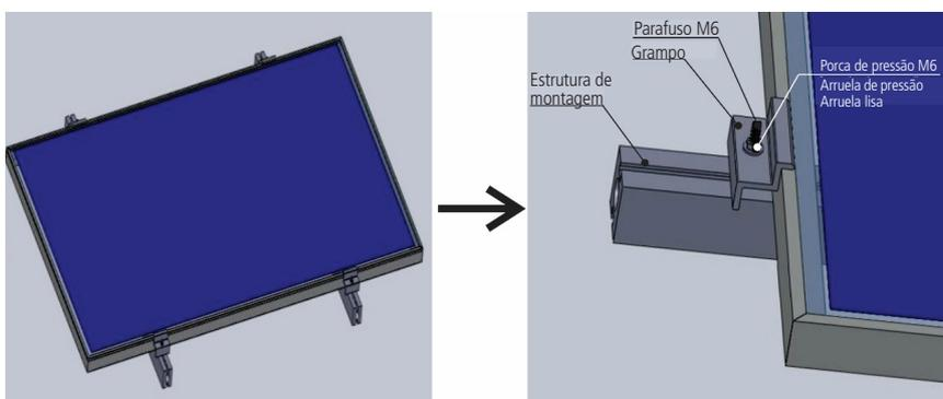
O módulo fotovoltaico pode ser instalado na posição paisagem, desde que as distâncias sejam respeitadas conforme figura abaixo. Para essa condição, a área de instalação dos grampos de fixação deverá ser, no máximo,  $\frac{1}{4}$  da largura do módulo fotovoltaico, com uma tolerância de  $\pm 50$  mm, a partir da borda da moldura do módulo.
