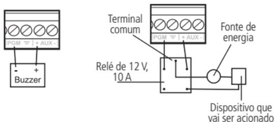
**Figura A:** ligação de um dispositivo que funcione em 12 V e consuma no máximo 50 mA, como por exemplo, um buzzer ou um LED (para ligar um LED é necessário colocar um resistor de 1 k $\Omega$  em série para limitar a corrente).
