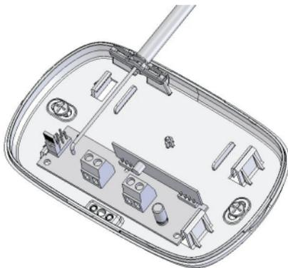
A figura anterior mostra o receptor XAR 2000 (opcional). Quando instalado, a central de alarme aumenta o raio de cobertura para dispositivos RF. Use-o quando houver a necessidade de instalação de sensores sem fio ou controles remotos em longas distâncias, cujo alcance na central fique comprometido. A ligação deve ser
