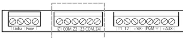
A ligação dos sensores com fio nos bornes das zonas da central de alarme deve ser feita com cabo 4 × 26 AWG ou superior, com comprimento máximo de 100 m e resistências total de 10 Ω. Estes bornes estão divididos em grupos de três terminais, sendo o do meio comum e os dos lados entradas para zonas. Por exemplo, para ligar um sensor na zona 1 ligue um dos fios no terminal COM e o outro no terminal Z1.
