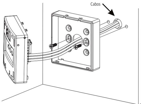
3. Monte o AS 2010 conforme a imagem a seguir. Alinhe e encaixe as abas inferiores das unidades (passo 1). Após, feche o produto pressionando a parte superior da unidade frontal (passo 2);
