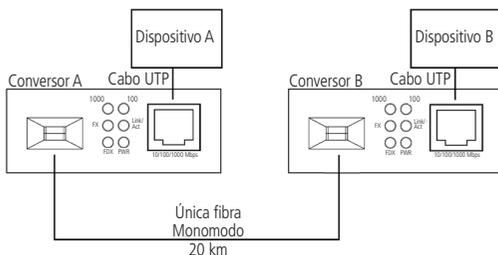
Obs.: os modelos KGSD 1120 A e B utilizam a tecnologia WDM na multiplexação do sinal óptico para a utilização em uma única fibra, sendo necessária a utilização dos conversores de mídia KGSD 1120 A e KGSD 1120 B simultaneamente.
