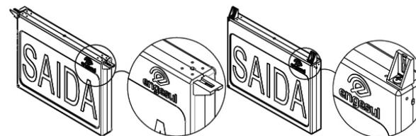
» Após a escolha da forma de instalação desejada, com auxílio de uma chave Philips, fixe os suportes nas furações correspondentes utilizando os parafusos menores do Kit de instalação.
