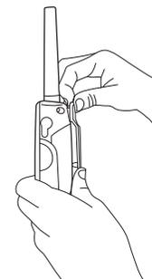
3. Com uma chave de fenda, desenrosque o parafuso da tampa traseira do rádio para abrir.
