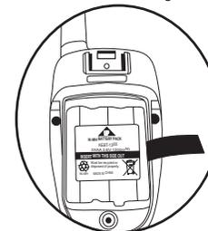
5. Alinhe a tampa e enrosque o parafuso para travar.
