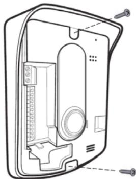
Parede (passe os cabos através da passagem de cabo na base, em seguida parafuse a base à parede)
