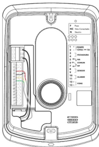
*Fixação dos cabos do ramal externo*
