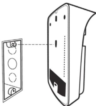
Caixa 4x2 (passe os cabos através da passagem de cabo na base, encaixe o ramal externo no parafuso fixado na parte superior da caixa, então parafuse o ramal externo na parte inferior da caixa)
