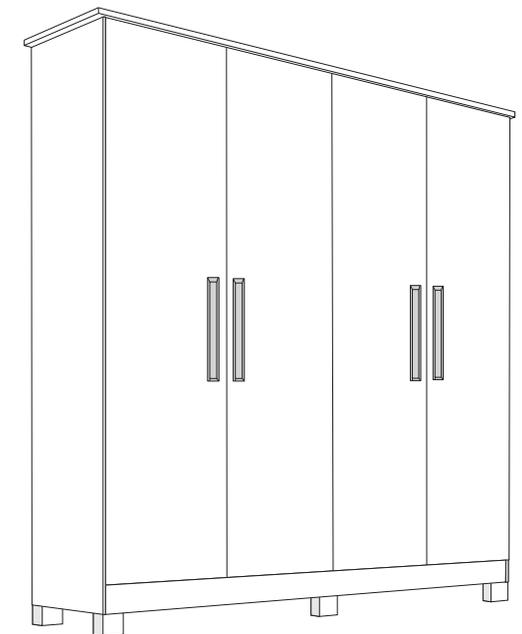
1° MONTAR OS PINAZOS (19) NOS RODAPÉS (17) E (18) COM CAVILHA 6 X 30 (C2) SEGUINDO AS FURAÇÕES. E COM CANTONEIRA METÁLICA (CT2) E PARAFUSO 3,5 X 12 (P1)
