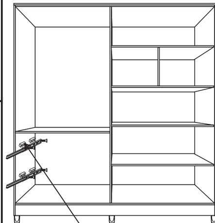
7° MONTAR O DISTANCIADOR (DI) COM PARAFUSO 4 X 16 (P6) SEGUINDO A FURAÇÃO.
